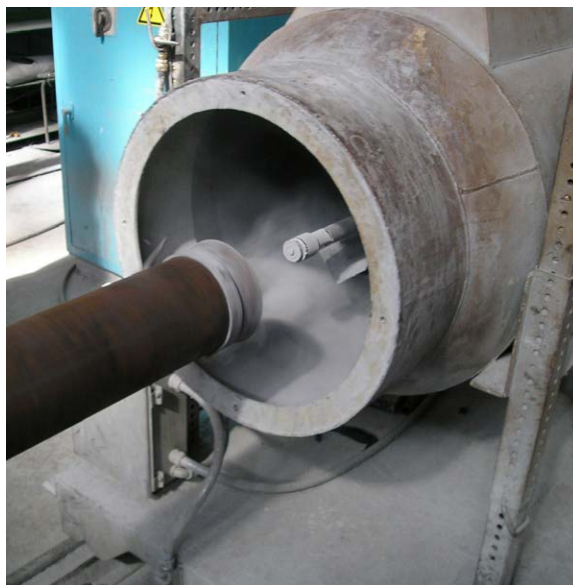
Нанесение внутреннего покрытия
